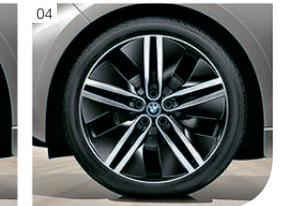
Die Leichtmetallräder des BMW i3 sind besonders schmal ausgeführt, um den Luft- und Rollwiderstand so weit wie möglich zu reduzieren. Der große Reifendurchmesser von 19" und 20" unterstützt den sportlich-agilen Charakter des Fahrzeugs und trägt dazu bei, die Reifenaufstandsfläche zu maximieren. Um unnötige Luftverwirbelungen zu vermeiden und damit die
