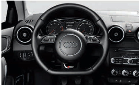
Multifunktions-Sportlederlenkrad im 3-Speichen-Design, unten abgeflacht Umfänge wie Multifunktions-Sportlederlenkrad im 3-Speichen-Design, zusätzlich unten abgeflacht
