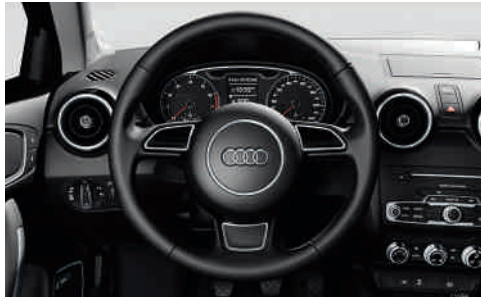
Sportlederlenkrad im 3-Speichen-Design in Höhe und Abstand einstellbar, mit Fullsize-Airbag; mit Schalt- bzw. Wählhebelknauf in Leder
