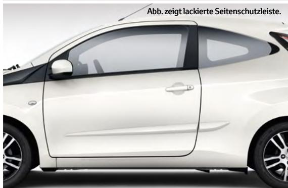
Abb. zeigt lackierte Seitenschutzleiste.
