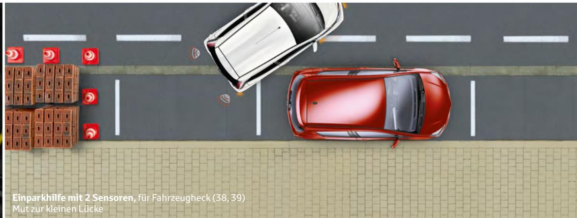
**Einparkhilfe mit 2 Sensoren, für Fahrzeugheck (38, 39)**
