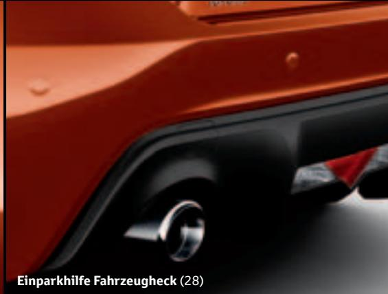
**Einparkhilfe Fahrzeugheck (28)**
