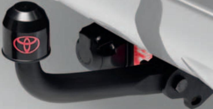
Anhängezugvorrichtung, horizontal abnehmbar (76)
